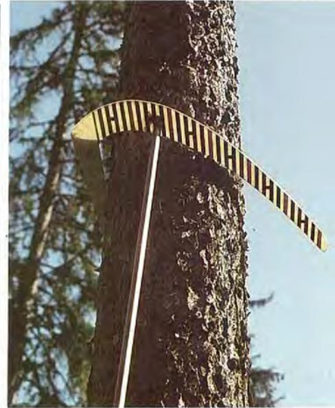
Messung des Durchmessers in 7 m Höhe:  $d_7 = 38$  cm
