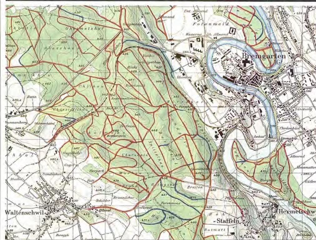
Dichtes Walderschliessungsnetz bei Bremgarten AG: rot = lastwagenbefahrbare Strassen
